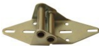
Krajní zavěš vrat s kladkou pro nylonové kolečko s označením pořadových čísel montovaných od země 2 až 5. Počet 3-5 párů
